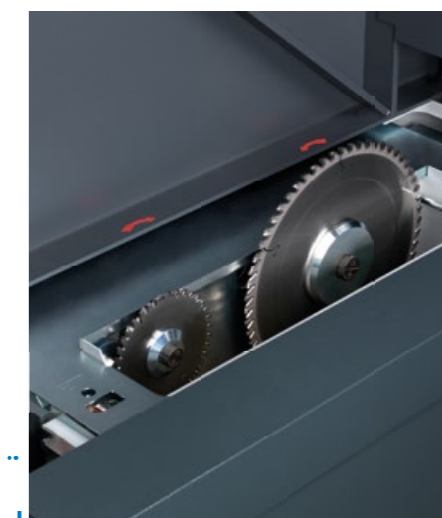
Wózek pilarki z agregatem piły głównej i podcinacza z precyzyjnym i niezużywającym się prowadzeniem.
