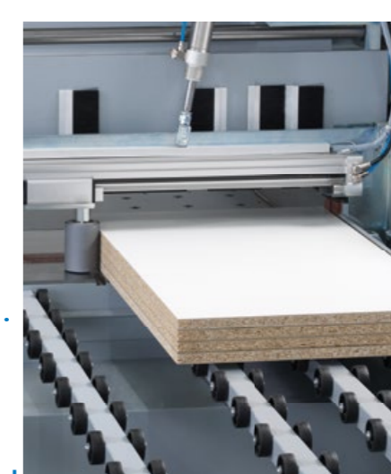
Zespół dociskający płyty do przyładnicy kątovej dba o ich delikatne i precyzyjne pozycjonowanie.
